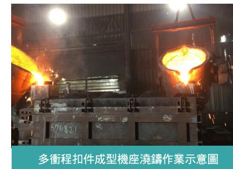
多衝程扣件成型機座澆鑄作業示意圖
