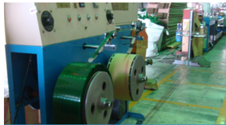
回收 PET 生產高值化打包帶產品示範生產線
