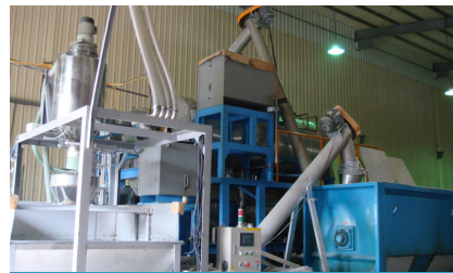
100%回收 PET 材料快速再結晶節能製程
