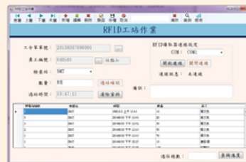
▲ 使用RFID標籤登錄在製品的工站資料
