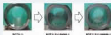
▲ 環氧樹脂之封裝模具外殼在不同封裝沖模次數之磨損圖。
