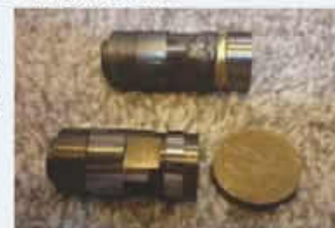
▲ 環氧樹脂之封裝活塞頂端切除再生處理結果
