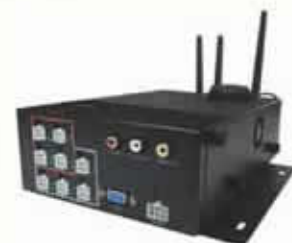
▲ 監控盒外觀，具有多種影音、網路、控制訊號的接孔
