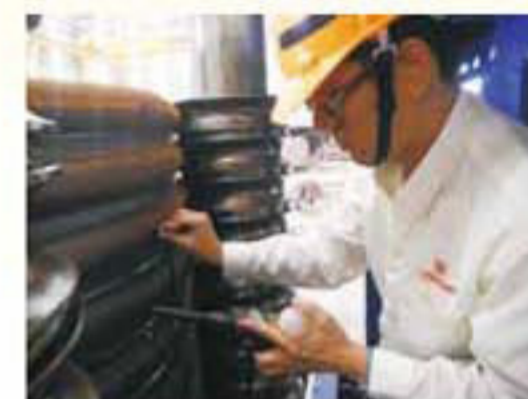
管排彎管設備試製品質確認
