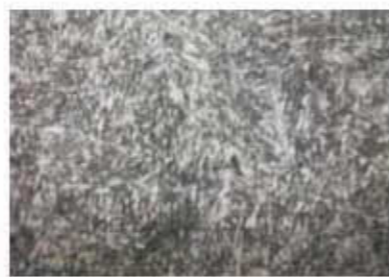
圖一、17-4PH 經熱處理 H1100 可觀察到條狀高角度晶界的麻田散鐵晶相
