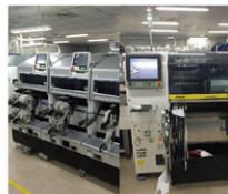
▲生產線F線、G線高速化機台投入物料定位在饋料架(freeder)上高速度置件
