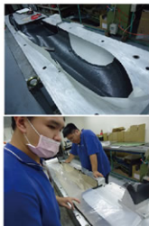
▲ 碳纖維預浸布貼模製作
