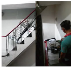
▲使用可爬樓梯的搬運車裝載重物上、下樓梯省時又省力
