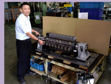
「快速換件夾治具」實體成品
