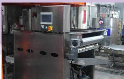
油炸機安裝油脂過濾系統
