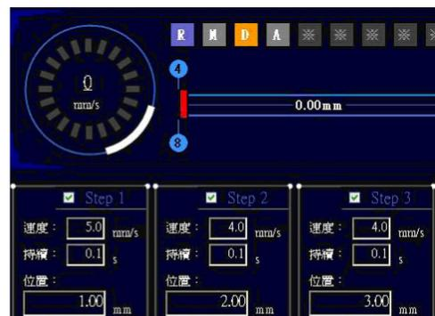
步進馬達多段控制系統操作介面示意圖
