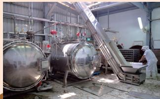
以殺菌釜設備進行高溫高壓處理
